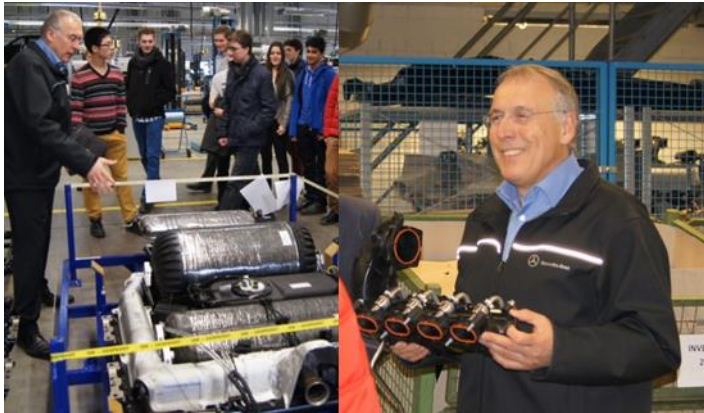
Georg Klohr erläutert den Schülern ein Erdgassystem für die E-Klasse (links) und ein Ladeluftmodul (rechts)
